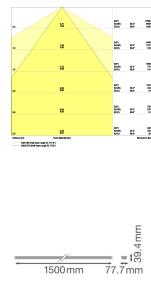
**Caractéristiques Ledvance LED Rail de fixation suspendu Trusys Flex Claire 70W 12100lm 2x30D - 840 Blanc Froid**
