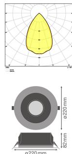
**Caractéristiques Ledvance Spot encastrable LED Performance DN195 21W 2520lm 65D - 840 | 220mm - IP54 - Dali Dimmable**
