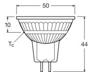
**Technische Daten Ledvance LED-Spot GU5.3 MR16 2.6W 350lm 36D - 827 | Ersatz für 20W**
