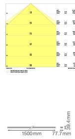
**Technische Daten Ledvance LED Tragschiene Trusys Flex Opal Stahl Weiß 70W 11700lm 90D - 840 Kaltweiß**
